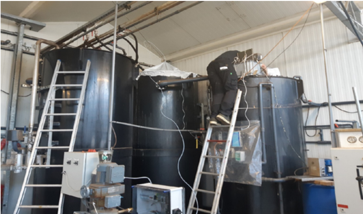
Foto 1 Bemonsteren uit het middelste vat met hulpmiddelen opgesteld op het rechter vat.
