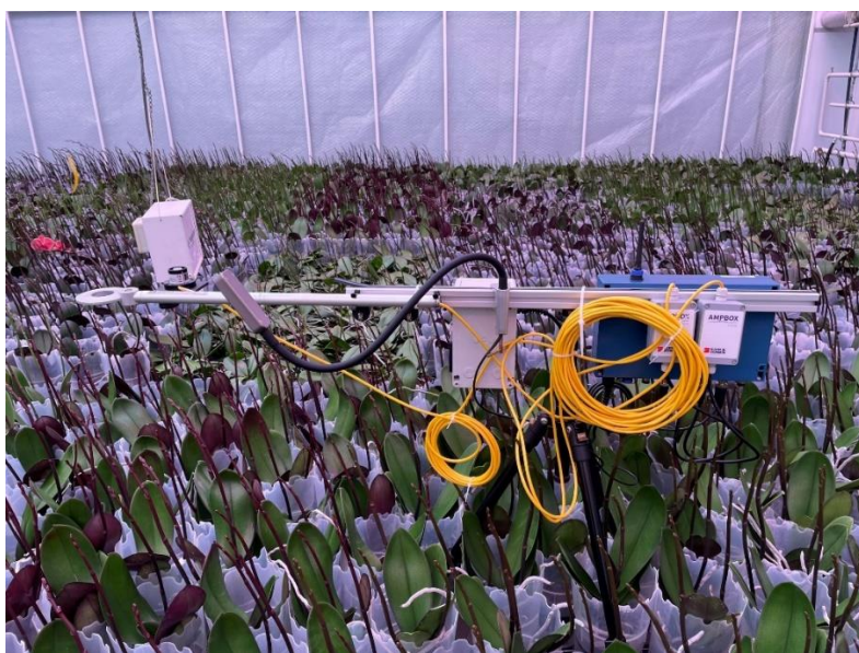
Foto 14. Fytawatch uitgerust met een PAR-meter, netto stralingsmeter, klimaatbox met temperatuur-, RV- en CO 2 -sensoren, en een planttemperatuurmeter (IR-sense).
