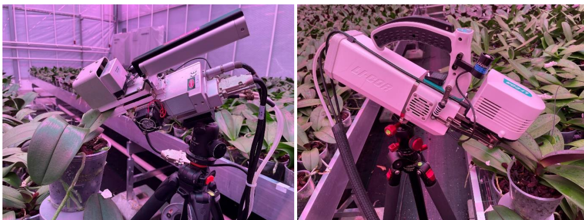
Foto 12. Meting van het lichtrendement en de CO 2 -opname met de Li-6400 (links) en de Li-6800 (rechts).
