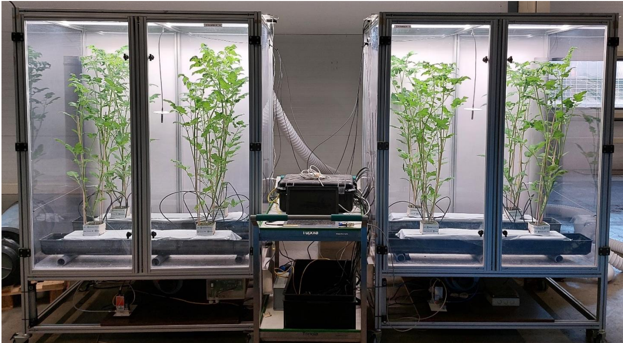
Figuur 3.3 Foto van de opstelling aan het einde van de proef. Links het kasje dat CO 2 kreeg uit de CO 2 batterij en rechts de referentiebehandeling.
