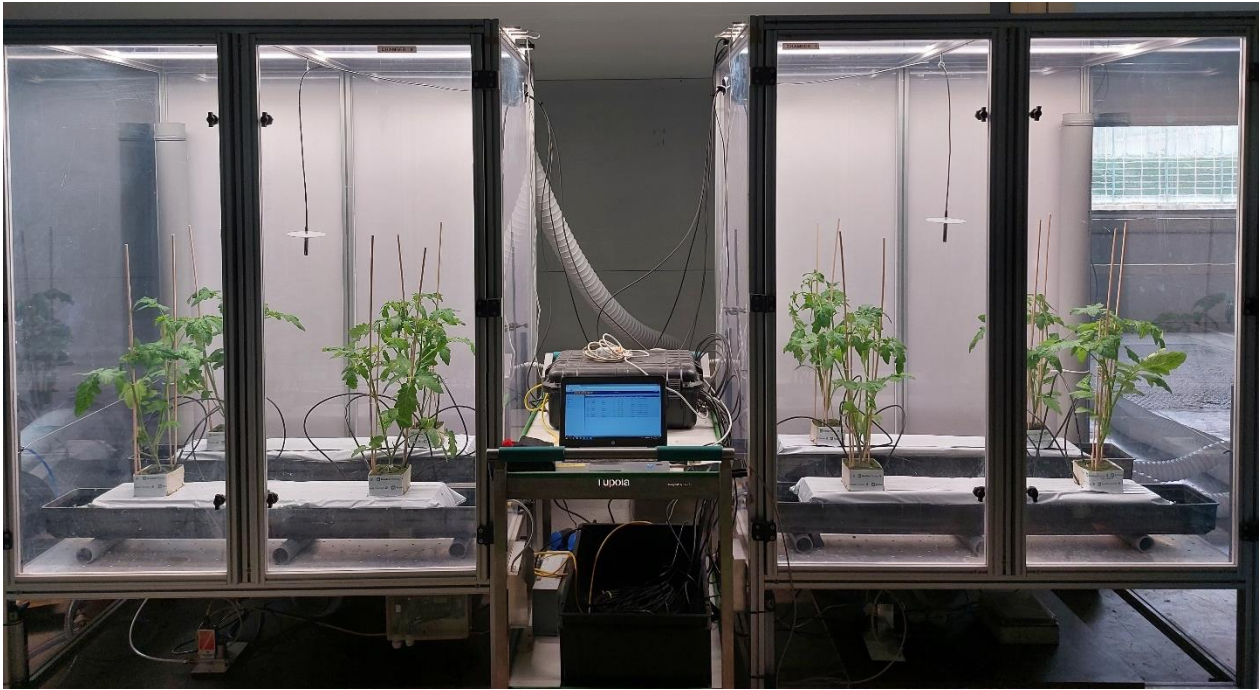
Figuur 2.1 Foto van de opstelling van de begassingskasjes in de loods bij aanvang van de proef. Links het kasje dat CO 2 kreeg uit de CO 2 batterij en rechts de referentiebehandeling.
