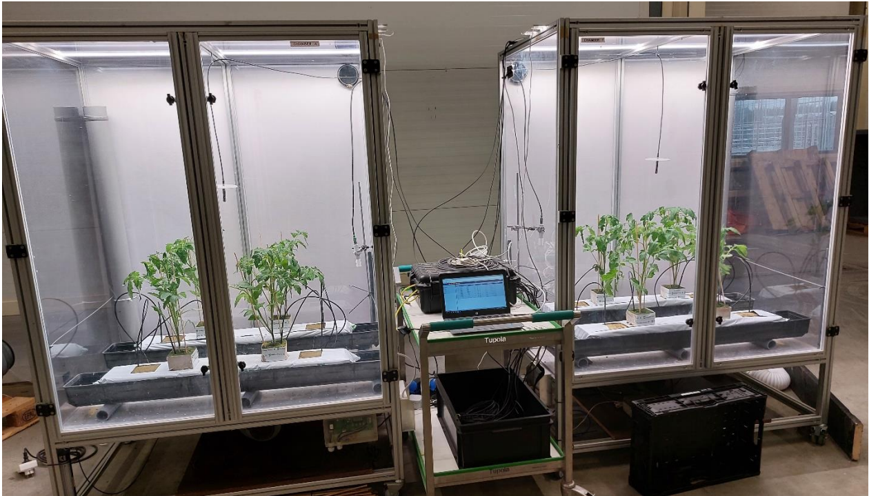
Figuur 2.1 Foto van de opstelling van de begassingskasjes in de loods bij aanvang van de proef. Links het kasje dat CO 2 kreeg uit de CO 2 batterij en rechts de referentiebehandeling.
