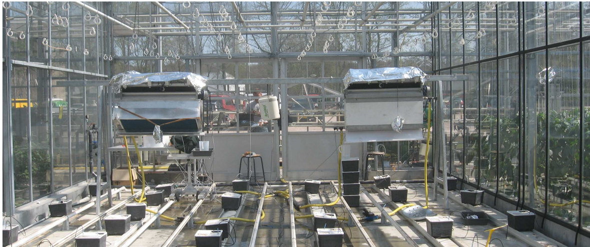
Figuur 10. Meetopstelling bij het PTC+ in ede waar naast de OPAC106 warmtewisselaar parallel aan de FWiHex warmtewisselaar is gemeten.
