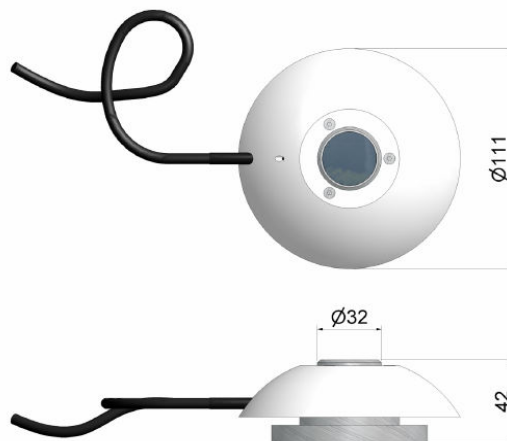
Figuur 1. De pyrgeometer (uitstralingsmeter) en afmetingen in mm (afbeelding uit brochure van Priva).
