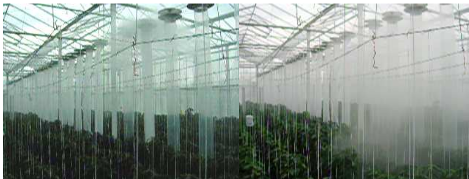
Figuur 12. Eerste foto: Begin van rookproef met zicht boven op het gewas. Rook is ingebracht bij de aanzuigmond van de koeling (te zien aan de rechter kant) en komt boven uit het verdeelstuk, waar het bovenin de kas in een wolk kort blijft hangen. Tweede foto: Vervolg van rookproef met zicht boven op het gewas. De meerderheid van de rook valt direct naar beneden in het pad meteen naast de koeling. Relatief weinig rook viel in het pad daarnaast (tweede pad vanaf de koeling, te zien aan de rechter kant).
