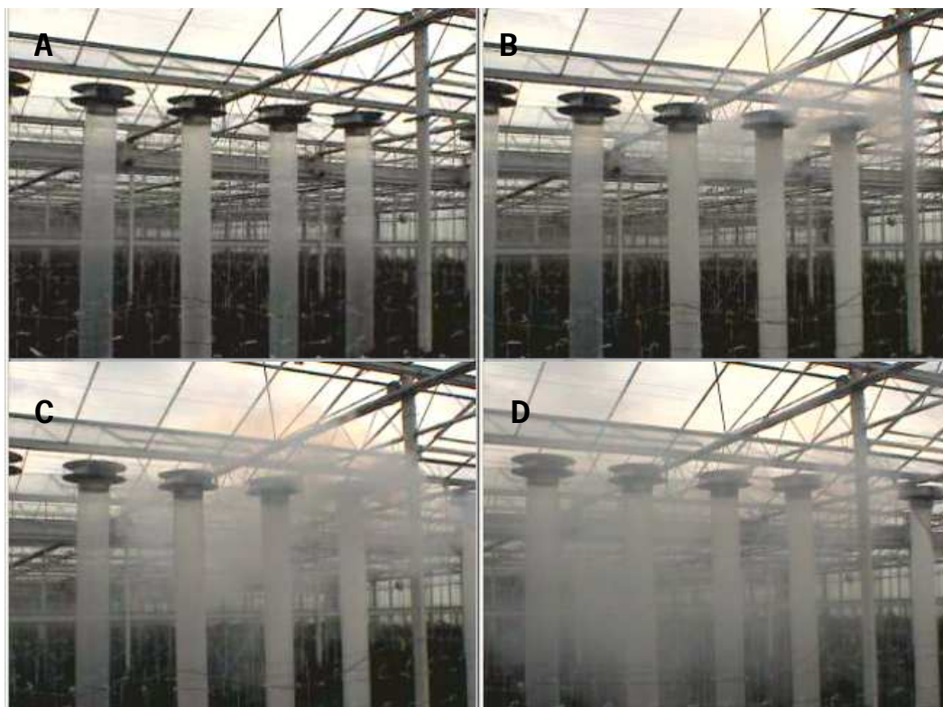
Figuur 16. Rookproef na aanpassing van uitblaasmonden. Bij een ventilator stand van 50% lijkt de snelheid waarmee de lucht de uitblaasmonden verlaat lager te zijn dan bij een ventilator stand van 90%, zoals te zien in foto B, maar wordt nog steeds op enige afstand van de JSK gebracht voordat deze lucht weer neerkomt. Dit is te zien op foto C en D, waar tevens is te zien dat de invloed van de kas ventilatoren, die hier de lucht horizontaal van rechts naar links verplaatsen, invloed hebben op de luchtbeving.
