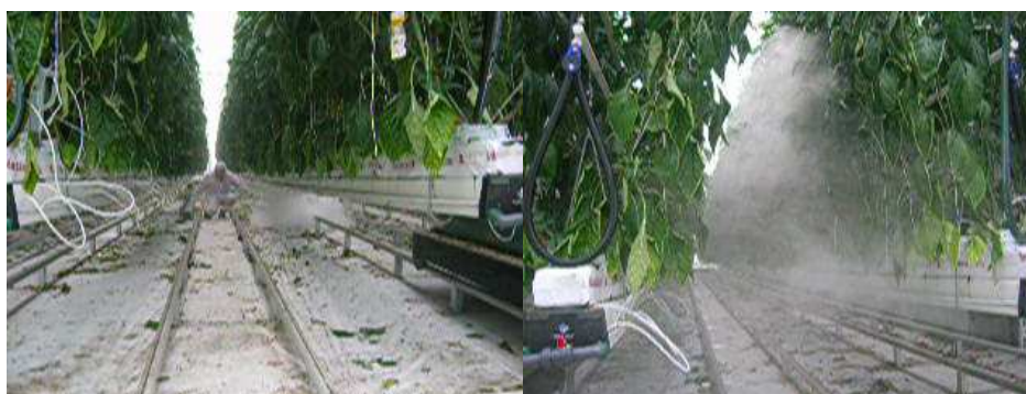
Figuur 14. Eerste foto: Rookproef met zicht onder het gewas. Rook afgegeven aan de andere zijde van het pad, onder de derdegoot, laat ook zien dat het zich weg van de koeling (aan de linker zijde van de foto) verplaatst, onder de goten aan de rechter kant langs. Tweede foto: Rookproef met zicht onder het gewas. De rook, die is afgegeven onder de derde goot, zoals te zien in de eerste foto, heeft zich hier onder de vierde goot door bewogen en stijgt nu langzaam omhoog en naar voren.
