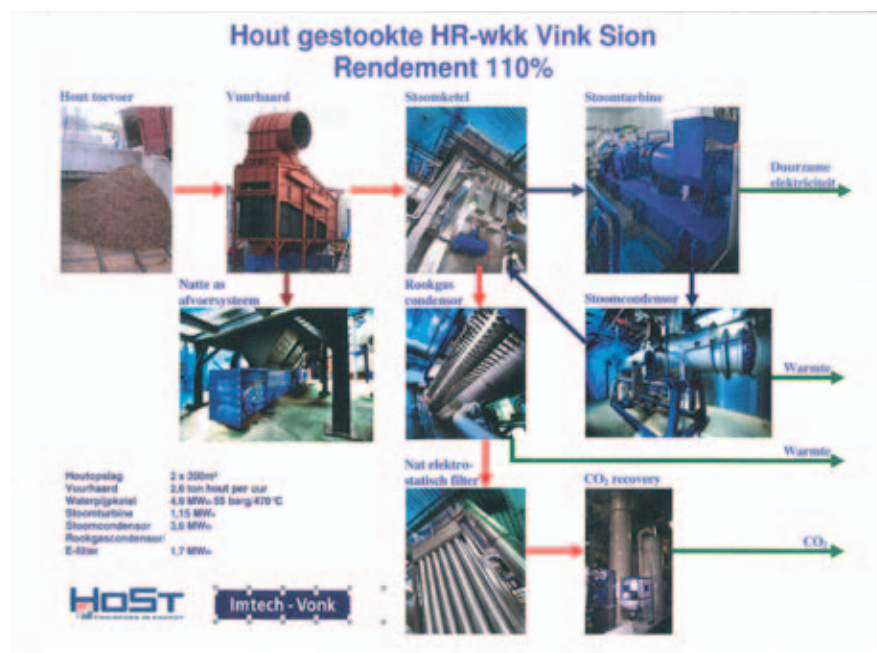
Figuur 8. Vink Sion, Beetgum: schema houtstook en CO 2 afvang.
