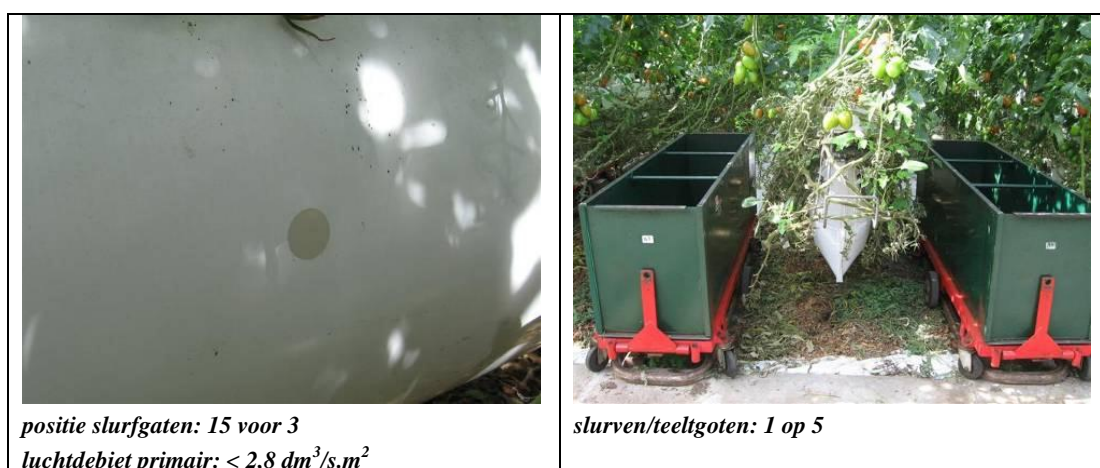
Figuur 26 Luchtsturven onder de teeltgoot
