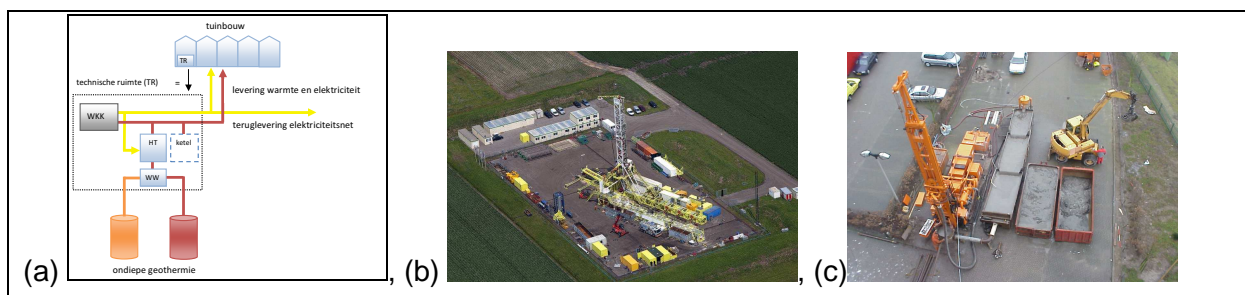
Figuur 1 (a) Schematische weergave toepassing ondiepe geothermie, (b) en (c) het verschil tussen een boorlocatie voor diepe (b) en ondiepe (c) geothermie.
