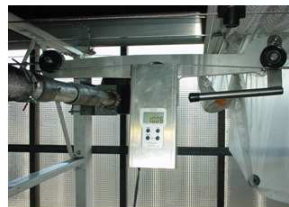
Meting van de voorspanning met een 3-punts buigproef
