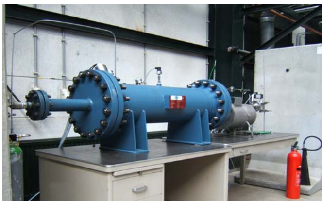
Figuur 15 HotCO 2 labopstelling: een holle buis met metaalkorrels
