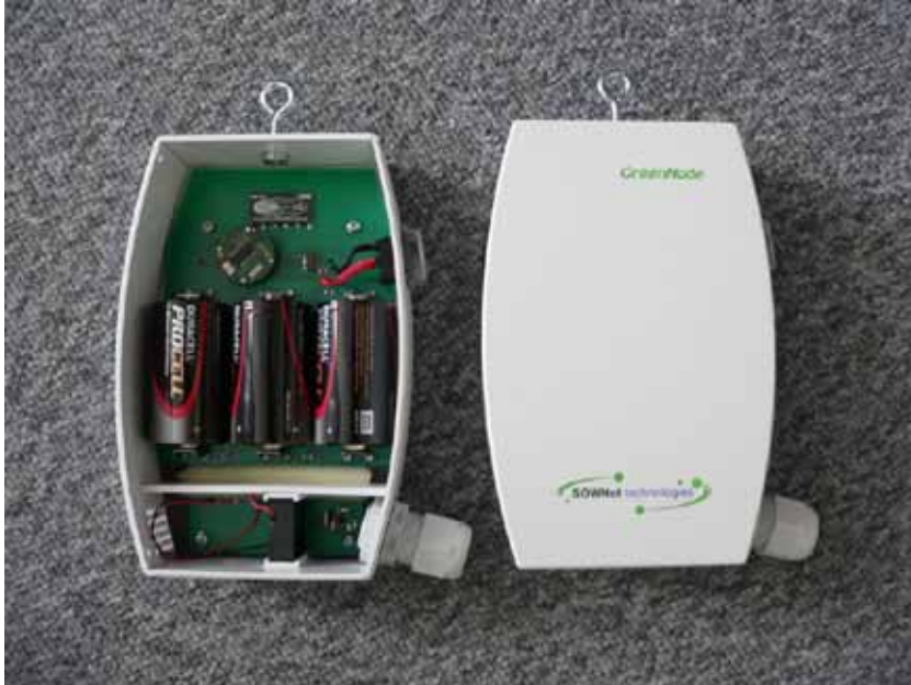
Figuur 3. Foto van de gebruikt sensor ten behoeve van de temperatuur en relatieve luchtvochtigheidsmeting.
