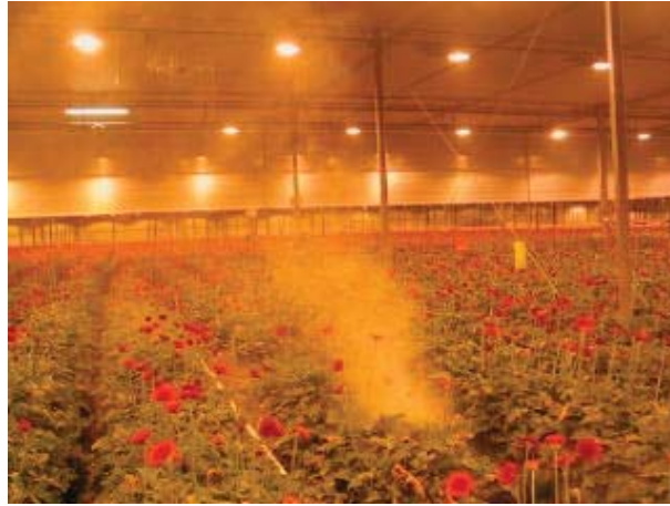
Figuur 8.2. Rook onder het bed gebracht, ventilatoren uit.
