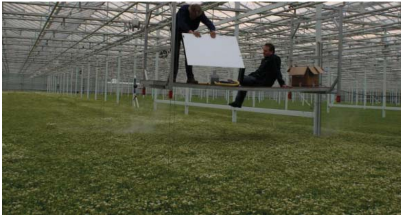
Figuur 8.16. Pulserende luchtbeweging door het bewegen van een vlakke plaat.
