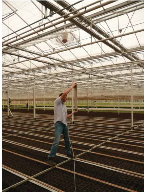
Figuur 8.19. Luchtsnelheidsmetingen waarbij de sensor wordt vastgehouden.
