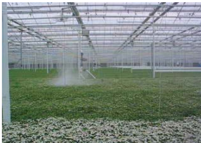
Figuur 8.15. Rook is in het gewas geblazen tussen twee ventilatoren in, maar komt pas onder de ventilator omhoog.
