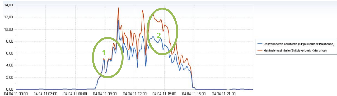
Figuur 13 Maximale en gerealiseerde fotosynthese, als de gerealiseerde assimilatie veel lager ligt dan de maximale assimilatie dan moet worden ingegrepen met bijv. verneveling en/of CO 2
