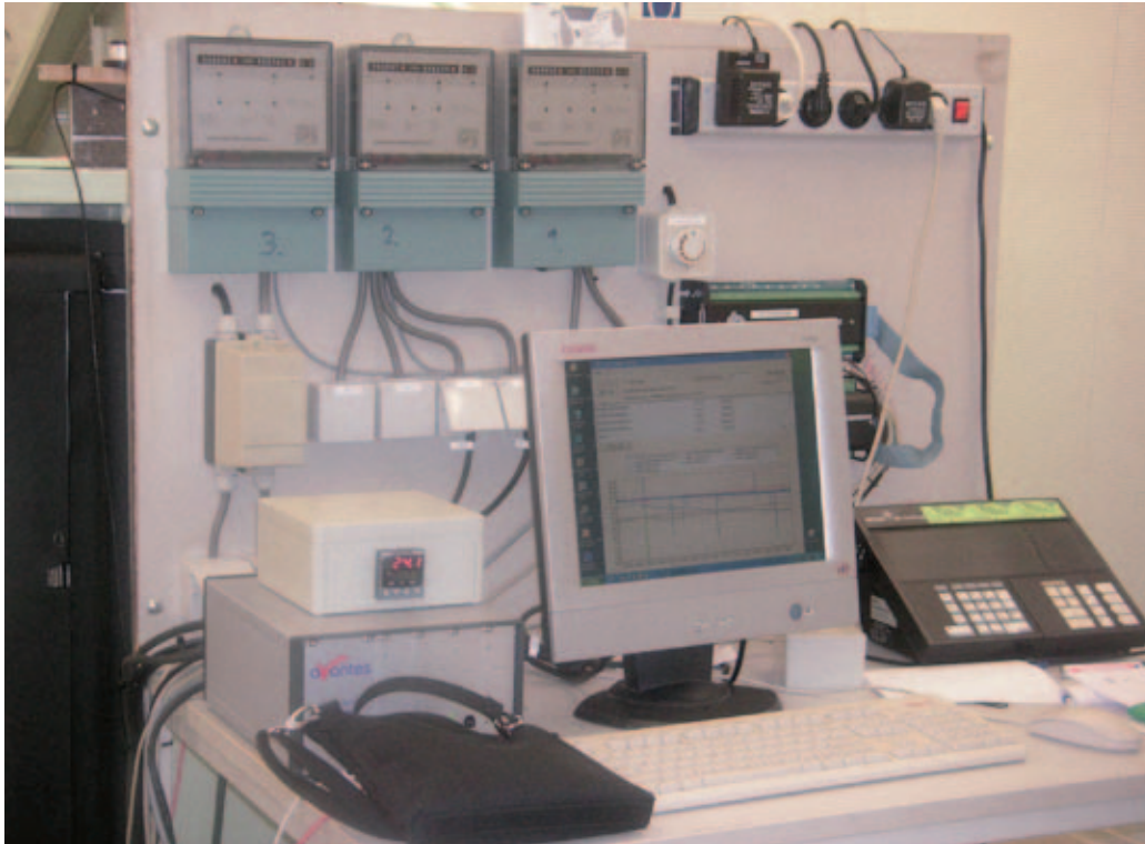
Figuur 5. Links boven de energiemeters van de verwarming van het kasje, de verdamper en de ventilator, rechtsonder de uitleesunit van de weegschaal waarmee de verdamperen werden gewogen, achter de monitor rechts de data taker
