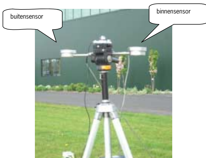
Figuur III.1. Ijking van de mobiele binnensensor met de vast op te stellen buitensensor.
