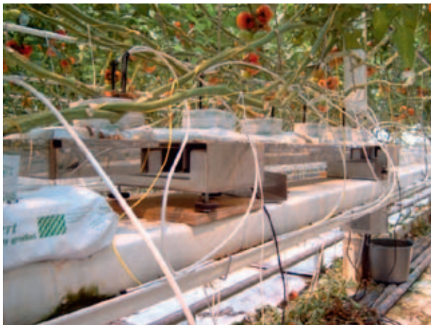
Figuur 4.2. De meetgoot voor de bepaling van de verdamping bij het Improvement Centre.
