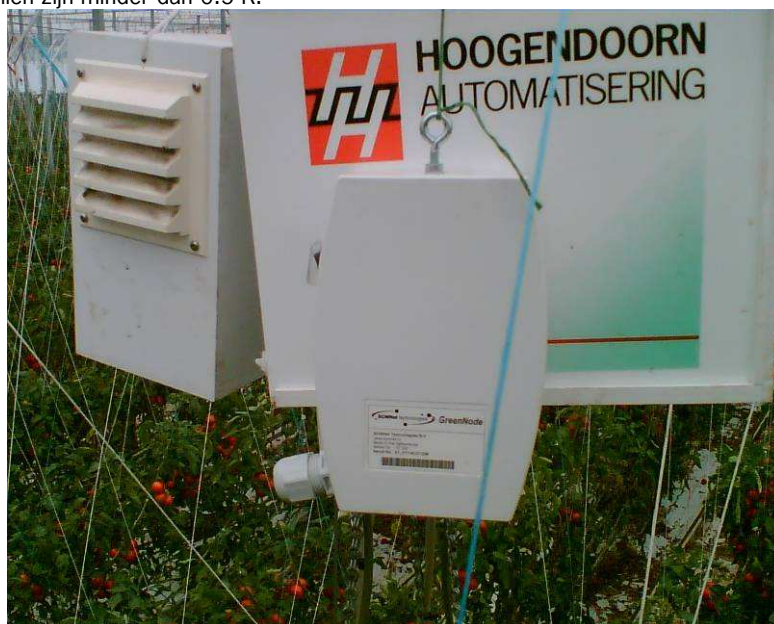
Figuur 33 Foto van de meetboxen, de "meetbox midden" en de draadloze sensor.
