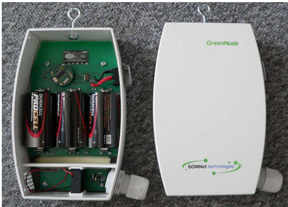
Figuur 10 Draadloze geventileerde temperatuur en vochtsensor
