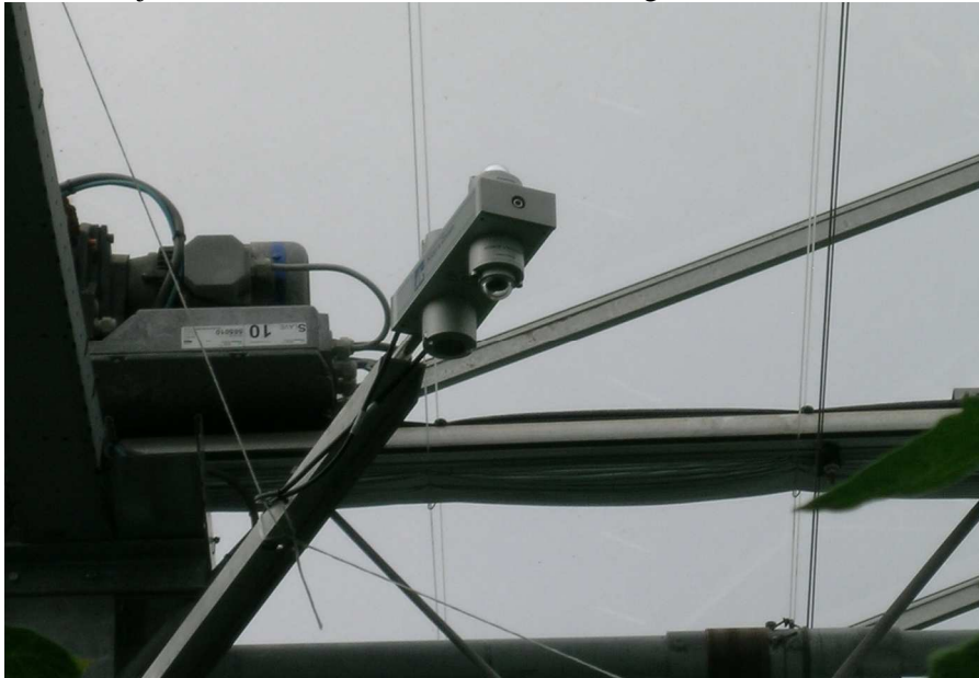
Figuur 13: netto stralingsmeter met 4 sensoren, 2 voor PAR+NIR (CM3) en 2 voor FIR (CG).
