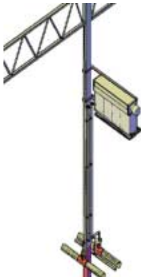
Figuur 4.2. Foto en schets van de nieuwste FiWiHex typen. De linker foto betreft een hangende variant die de lucht van onder aanzuigt en bovenlangs naar voren uitblaast (in de foto naar rechts). De rechter foto is een uitvoeringsvorm die op de grond wordt gezet. De lucht wordt van boven aangezogen, gaat dan door de warmtewisselaar, keert onderlangs om en wordt vervolgens opzij geblazen (in deze foto naar rechts).
