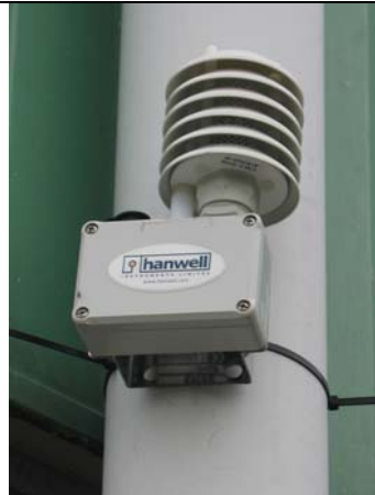
Hanwell draadloze temperatuur- en RV sensor, met ingebouwde datalogger
