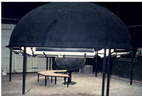
Figuur 3. Meetapparatuur voor het bepalen van de transmissie voor direct en diffuus invallende straling, integreernde Ulbricht-kogel.
