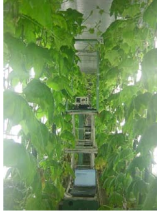
figuur 24 Proefkas PPO Naaldwijk met verticale verlichting tussen het komkommengewas. Op de buisrailwagen is de meetopstelling te zien waarmee het lichtniveau in de kas is gemeten.
