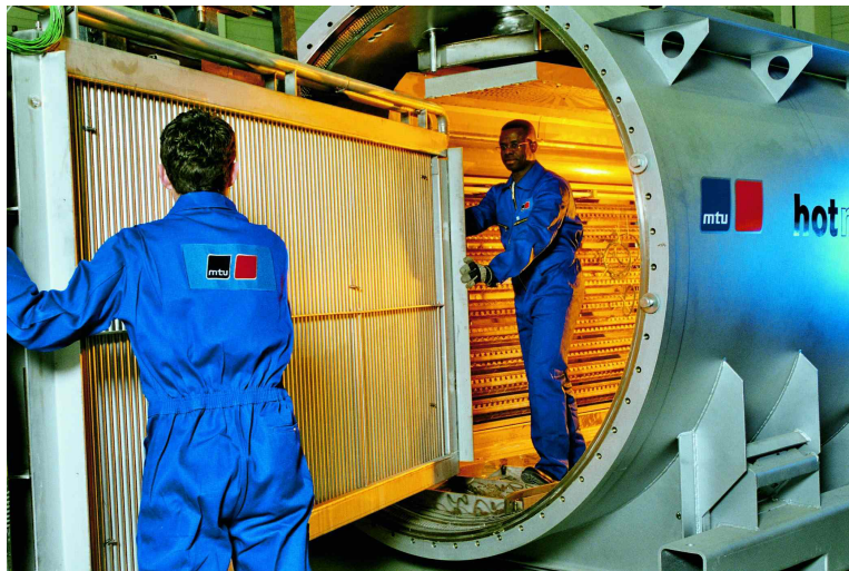
Figuur 3.4 Assemblage van Hot-Module (bron: MTU)
