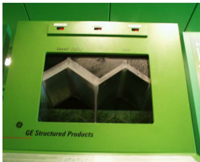
Fig. 7-1 Foto van de opstelling van de warmte isolatie van het dubbelzigzag kasdek in de demonstratie ruimte van de "Kas van de Toekomst".
