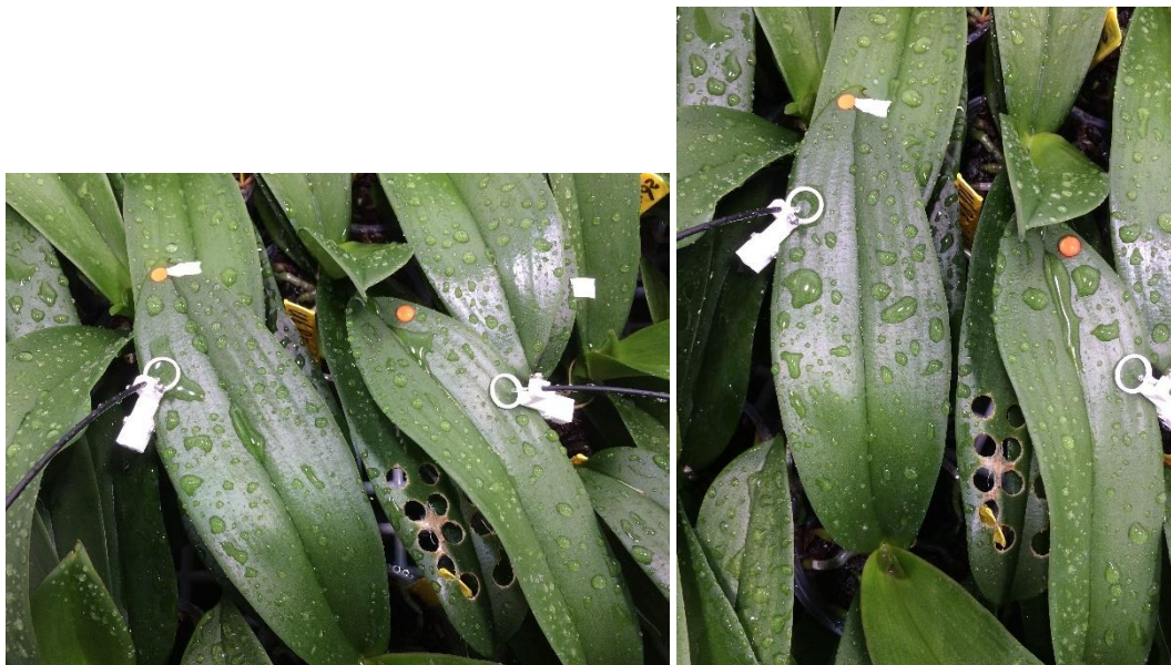
Foto 3. Effect van watergift op functioneren bladclip. De linkerfoto is om 9:00 genomen en de rechterfoto om 10:00. Te zien is dat in eerste instantie er water in de ring blijft staan. Een uur later is dit niet meer zichtbaar. 's Middags waren de planten droog.
