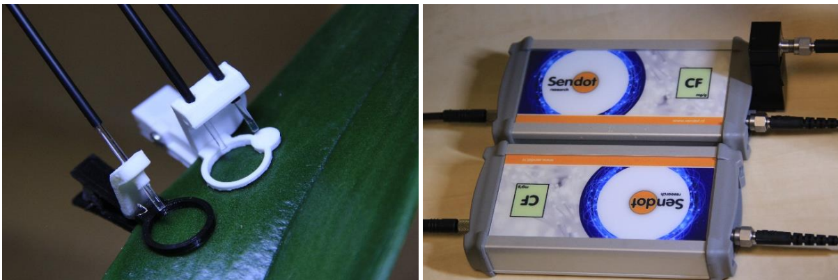
Foto 2. Ontwikkeling van een indicatieve PAR-meting net naast de fluorescentiemeting via reflectie van licht dat via een tweede fiber geleid wordt naar een detector.
