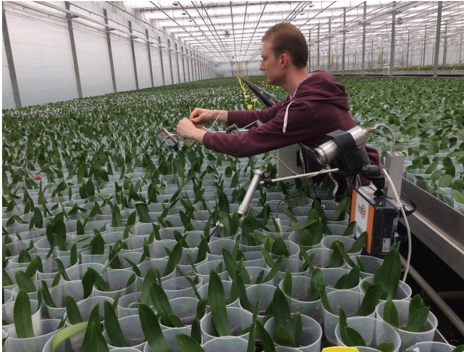
Foto 4 . Praktijktoets bij SO natural met prototype sensoren. De sensoren zijn rondom een Plantivity geplaatst om een direct vergelijk tussen de twee types sensoren mogelijk te maken.
