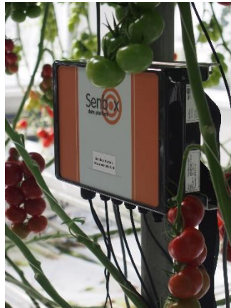
Foto 6. De Senbox van Sendot B.V.. Hier kunnen 5 willekeurige sensoren aan gekoppeld worden. De data komt via een 4G modem direct via internet beschikbaar.
