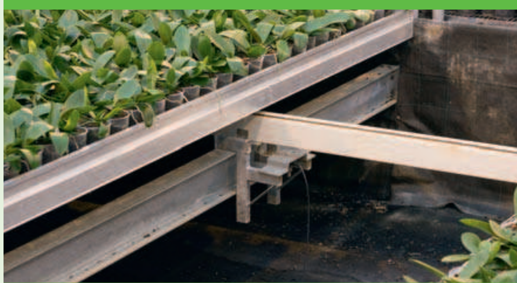
Op de transportbuizen is een weeginstelling aangebracht die het gewicht van een container met planten registreert.
