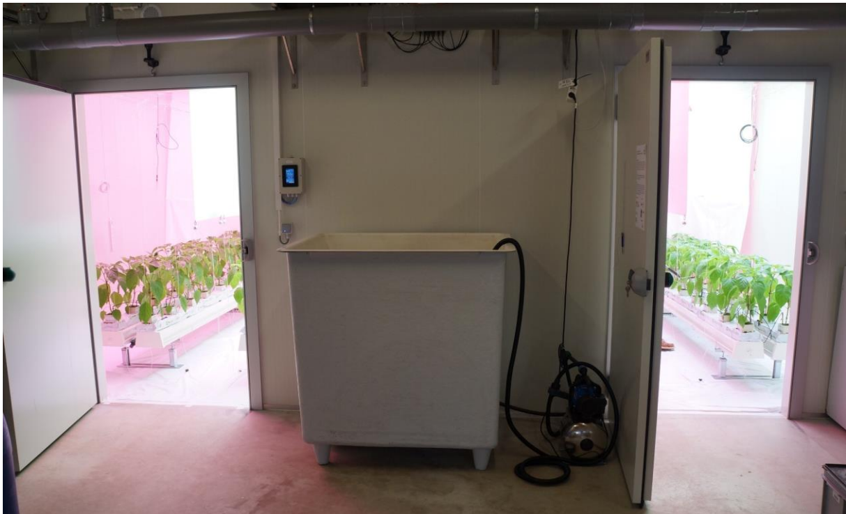
Figuur 2.1. Overzicht van de klimaatcellen van Plant Lighting waar verschillende lichtspectra en daglengtes werden getest. Binnen een klimaatcel werden vier zones aangelegd met ieder een verschillend lichtspectrum. Er werd geteeld op een dubbele goot aan de hoge draad. In de linker klimaatcel werd een maximale daglengte van 15 uur aangehouden en in de rechter klimaatcel 18 uur.
