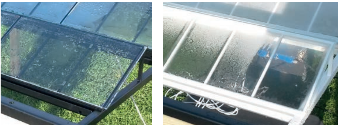
Figuur 23 Natslag op het glas heeft grote invloed op de lichttransmissie en lichtverstrooiing en kan niet meegenomen worden in de berekeningen. Het gebruikte diffuse glas (rechts) kan vrijwel helder worden bij condensatie maar ook sterker diffuus en deze effecten kunnen zelfs zeer lokaal optreden zoals in de figuur rechts zichtbaar is.
