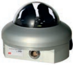
Figuur 8 De SPN1 Pyranometer van Delta-T Devices LTD waarmee de verhouding tussen directe en diffuse straling gemeten is.
