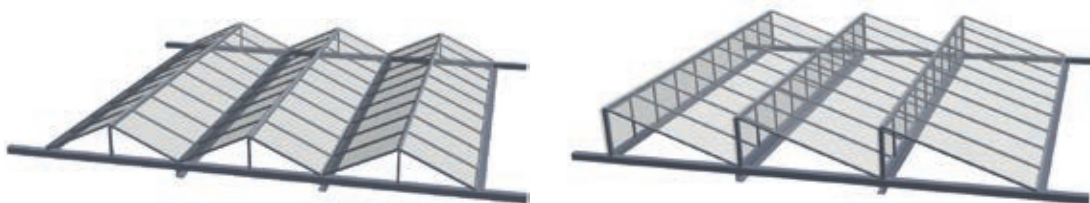
Figuur 3 3D model van Venlo en zaagtand zoals gebruikt voor het simulatiemodel.
