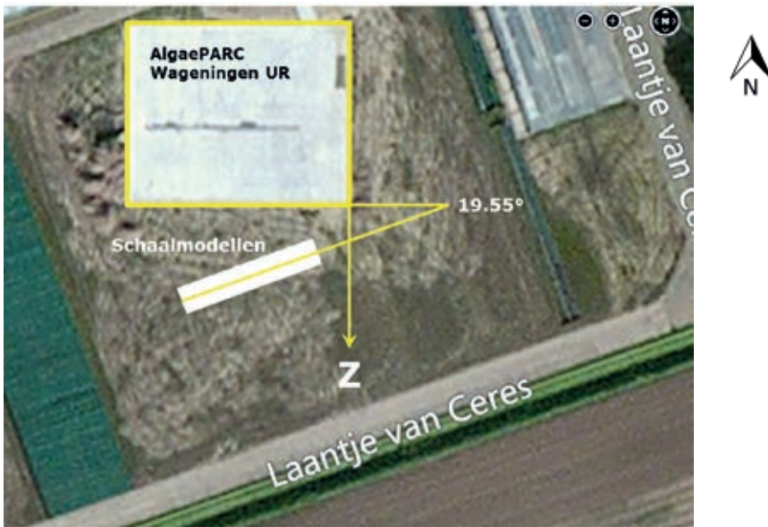
Figuur 10 Satellietfoto van de betonnen fundering van het AlgaePARC van met daarin geschetst de locatie en de oriëntatie van de schaalmodellen. De offset ten opzichte van het zuiden bedraagt 19.55°.
