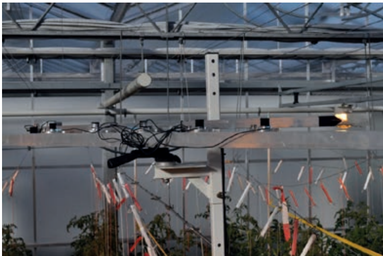
Foto 2. Opstelling van 1 lijnsensor met 5 puntsensoren bovenin de kas.
