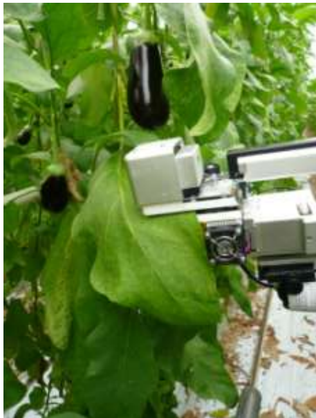
Foto1: meting van de fotosynthese met de Licor-6400 aan een topblad. Bij het meetblad kunnen de lichtomstandigheden, de CO 2 concentratie, de temperatuur en de relatieve luchtvochtigheid gevarieerd worden. Hierdoor kan de korte termijn reactie van de fotosynthese op deze veranderingen bepaald worden.
