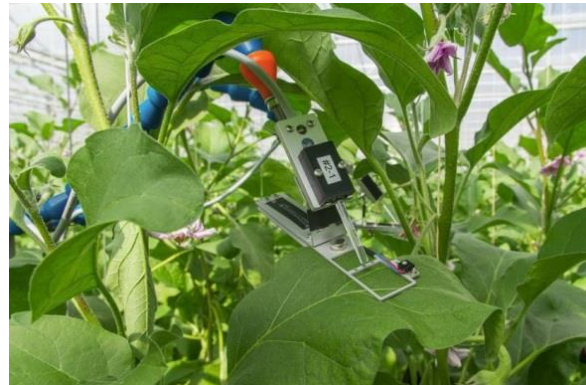
Figuur 4.7.1 van meetkop 1 van de Hex-PAM meter 2 in de referentie afdeling. Meetkop 1 was boven in het gewas gemonteerd.
