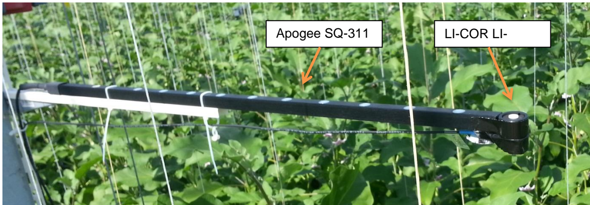
Foto 1: meting van het lichtniveau in de kas, enkele decimeters boven de kop van het gewas. Deze nulmeting is een gecombineerde meting van een Apogee SQ-311 en een LI-COR LI-190SZ. Het verschil tussen deze nulmeting en de lager gepositioneerde lichtmeters geeft de mate van lichtonderschepping
