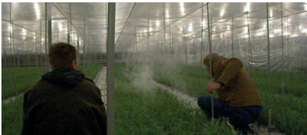
Figuur 22. Rook inblazen met sluf van 15 cm in de folietent (jong gewas).
