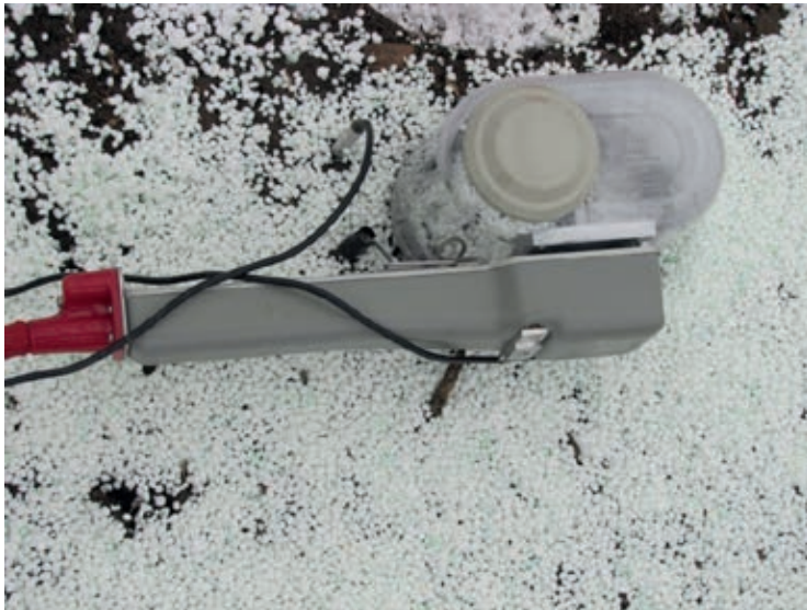
Figuur 4. Meting van de bodemverdamping met de LCPro+ en "soil respiration hood".
