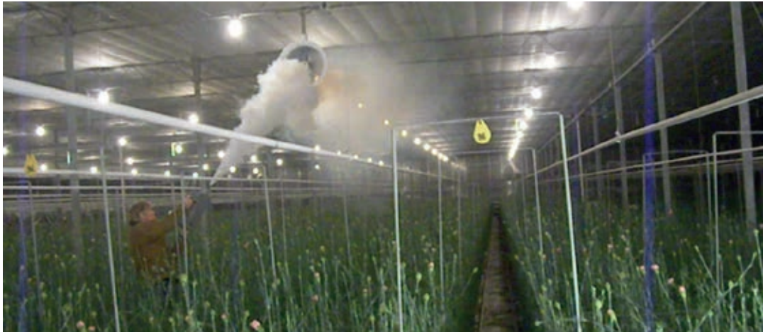
Figuur 23. Rook blazen vlak bij de ventilator op een midden-stand.
