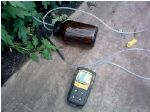
Figuur 11: Gasmeting met de handmeter en de monster fles voor 1 L gasmonsters.
