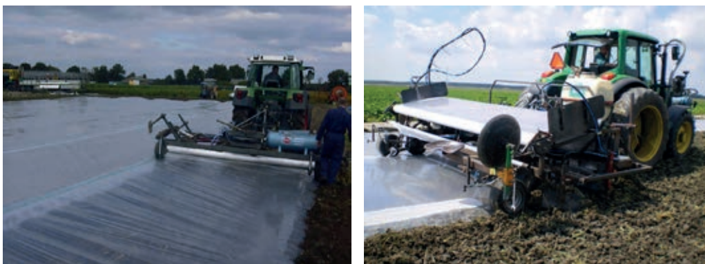
Figuur 14. en 15: Machinaal leggen van folie (Bron: www.kennisakker.nl )
