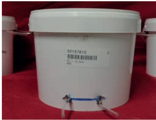
Figuur 18. en 19: Emmers in celproef, met aansluitingen voor metingen van omzettingproducten van het proces.
