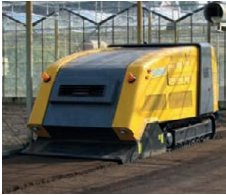
Figuur 4: Hete-luchtbehandeling (Cultivit) in praktijk Figuur 5: Schematische tekening Cultivit (Bron: www.vdlcultivit.nl )
