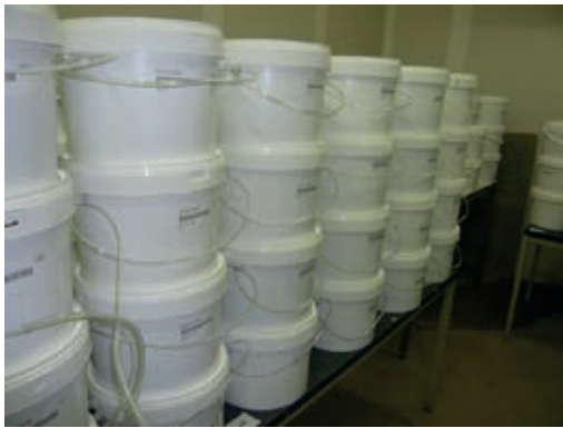
Figuur 18. en 19: Emmers in celproef, met aansluitingen voor metingen van omzettingproducten van het proces.
