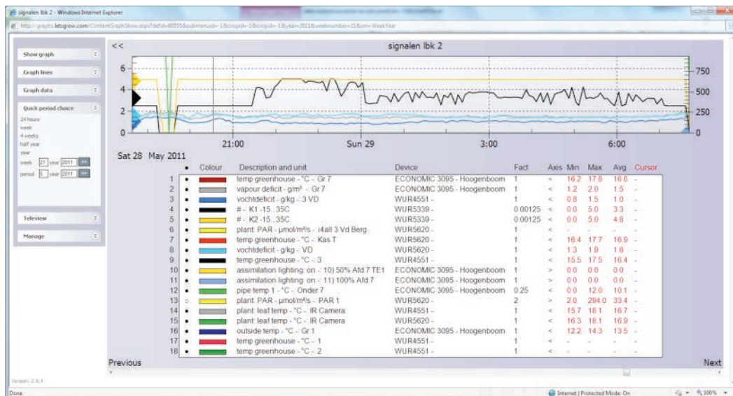
Figuur 2. Grafiek uit LetsGrow uit de nacht van 28 op 29 mei 2011 met de ventilator op minimaal 50%.
