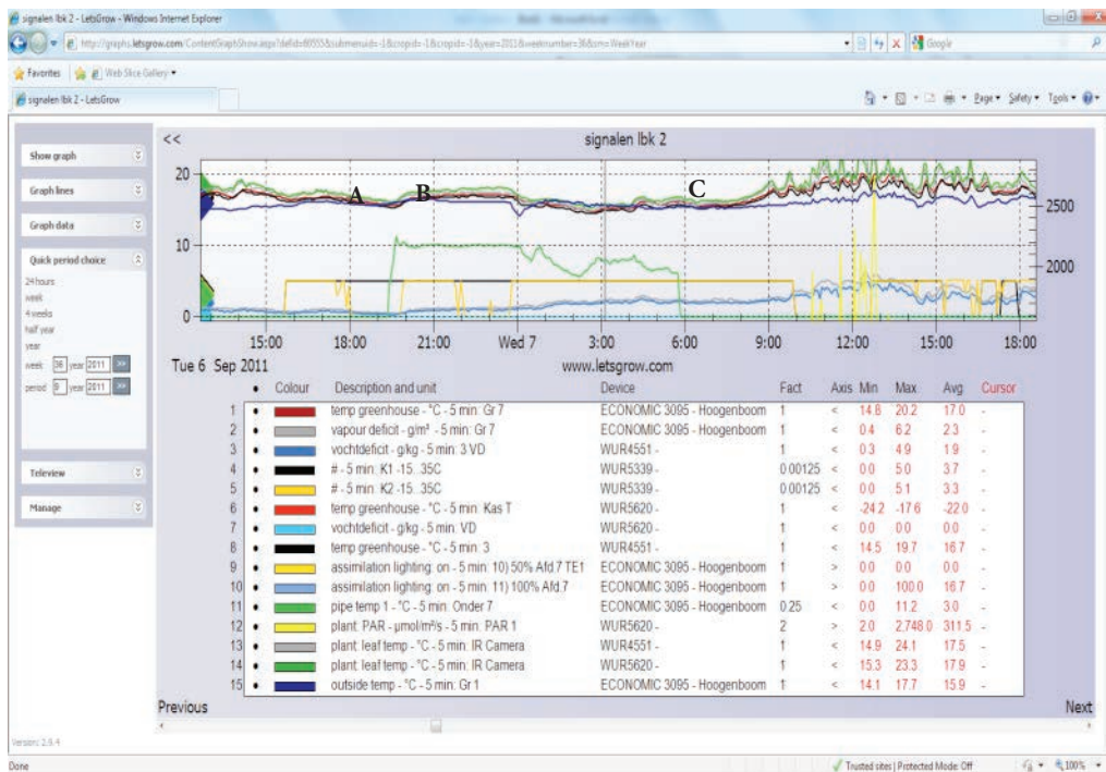
Figuur 1. Grafiek met regeling van ventilator en buitenluchtklep voor de nacht van 6 op 7 sept.
