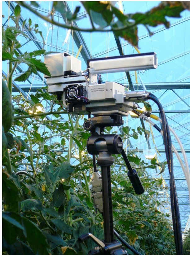
Figuur 9.3. LiCor-6400 meetapparatuur. Assimilatieparameters en fluorescentie (ETR) werden gemeten met de LiCor 6400. In de meet cuvette van deze apparatuur (aan boven- en onderzijde van het ingeklemde blad) worden lichtintensiteit, \text{CO}_2 concentratie, temperatuur en de relatieve luchtvochtigheid door een computerprogramma ingesteld en gevarieerd. Hierdoor kan de reactie van de assimilatie op deze veranderingen bepaald worden. Een fotosynthese van 10 \mu\text{mol m}^{-2} \text{s}^{-1} op bladoppervlakte basis, komt overeen met een groei van 1 gram drogestof per \text{m}^2 blad per uur. Stel dat we een dergelijke fotosynthese gedurende 10 uur kunnen handhaven dan is er voldoende energie vastgelegd om 10 g drogestof te assimileren per vierkante meter blad.
