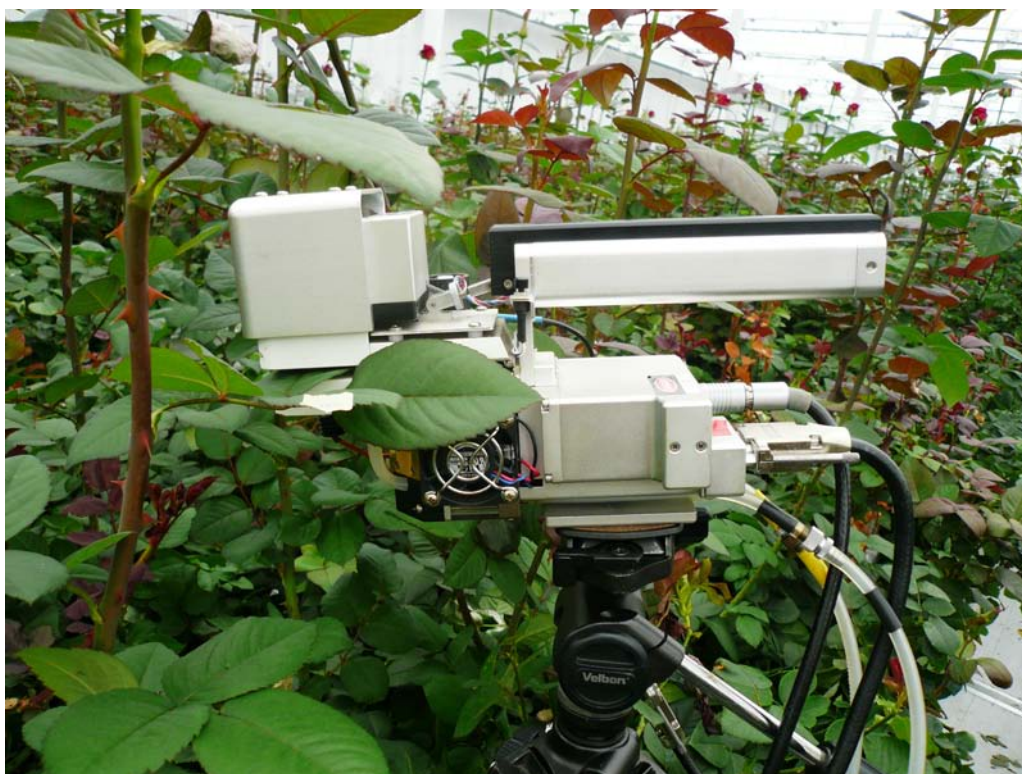
Figuur 4.1. LiCor-6400 meetapparatuur. Assimilatieparameters en fluorescentie (ETR) werden gemeten met de LiCor 6400. In de meet cuvette van deze apparatuur aan boven- en onderzijde van het ingeklemde blad) worden lichtintensiteit, CO 2 concentratie, temperatuur en de relatieve luchtvochtigheid door een computerprogramma ingesteld en gevarieerd. Hierdoor kan de reactie van de assimilatie op deze veranderingen bepaald worden. Een fotosynthese van 10 \mu\text{mol m}^{-2} \text{s}^{-1} op bladoppervlakte basis, komt overeen met een groei van 1 gram drogestof per m 2 blad per uur. Stel dat we een dergelijke fotosynthese gedurende 10 uur kunnen handhaven dan is er voldoende energie vastgelegd om 10 g drogestof te assimileren per vierkante meter blad.
