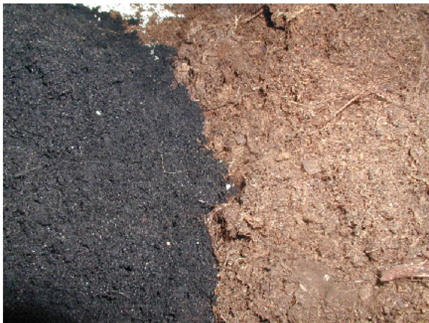
Figuur 3 Links gestoomde grond met zanderige structuur, rechts diëlektrisch ontsmette grond
