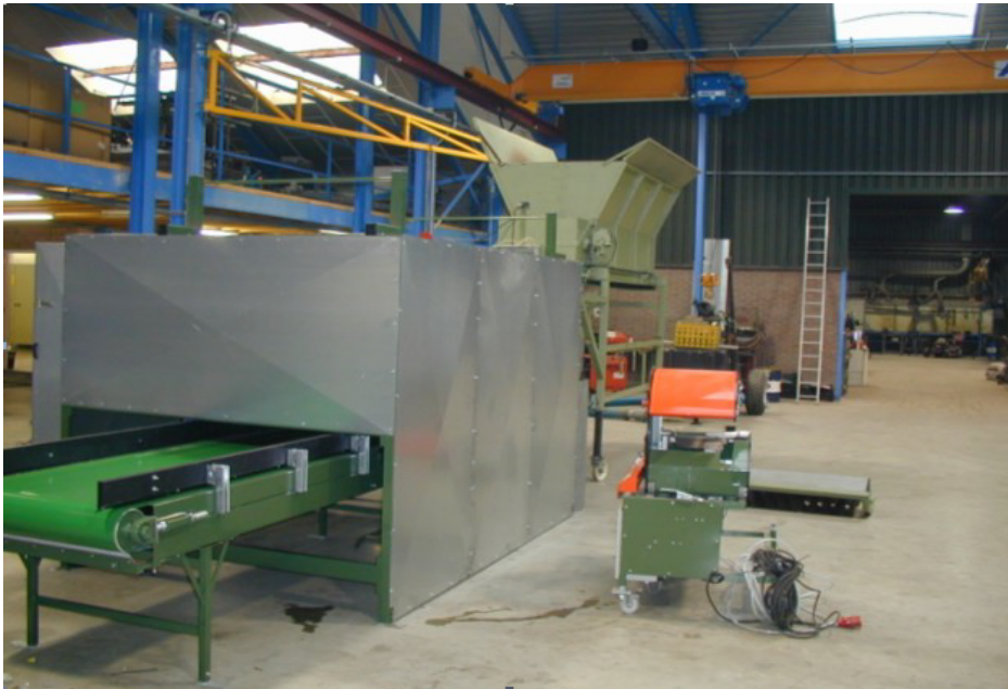
Figuur 7 Foto van de diëlektrische ontsmetting opstelling
