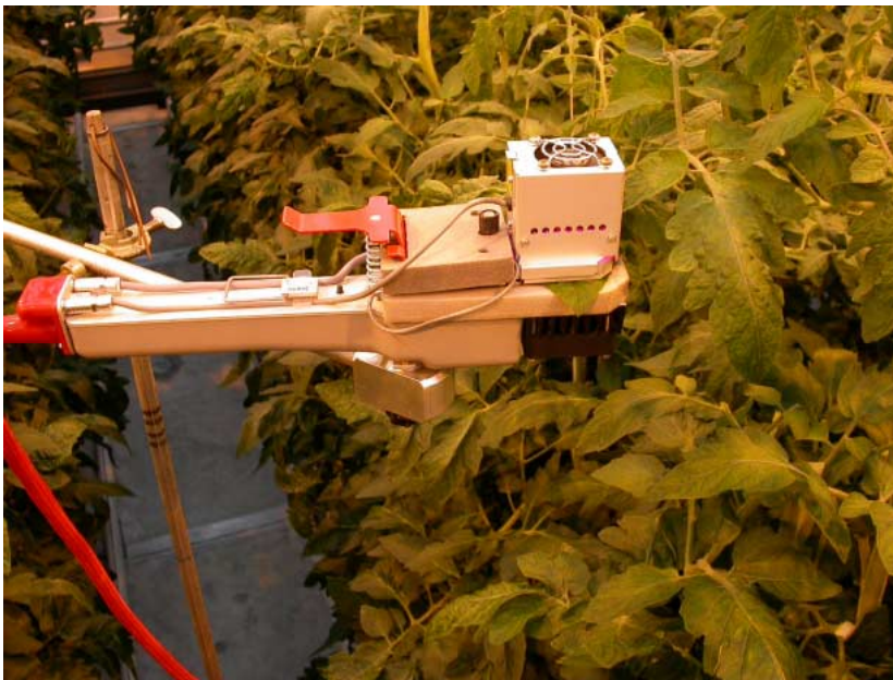
Tomatenblad in de bladkamer van de fotosynthesemeter met een ingebouwde lichtbron erboven.
