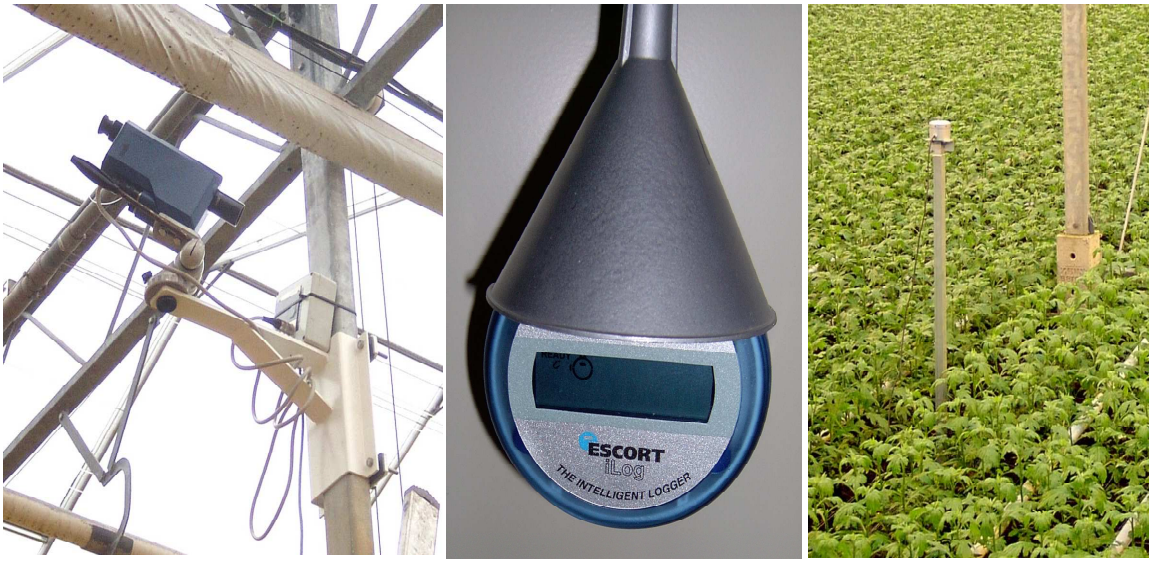
Foto 2:V.I.n.r.: Infraroodcamera voor meting planttemperatuur, mini-datalogger voor RV en temperatuur in gewas, PAR meter
