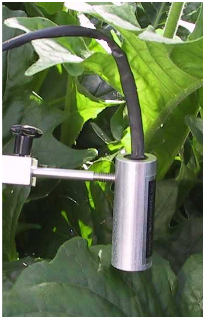
IR meting voor bladtemperatuurmeting op buishoogte (links) en sapstroommeting (rechts)
