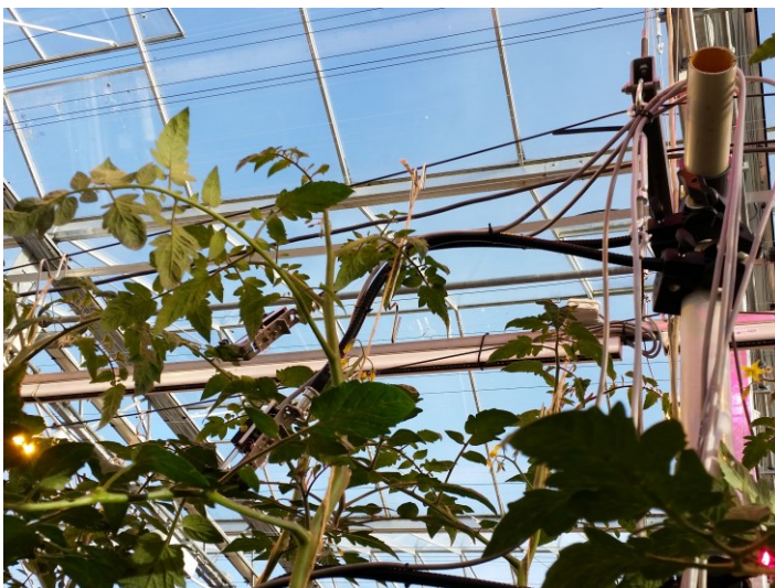
Figuur 5.3. De meetpaal met de HEX-PAM sensoren (2 zichtbaar) gemonteerd aan flexibele zwanenhalzen die met klemmen aan de PVC buis bevestigd zijn. Zichtbaar zijn de sensoren 1 en 2 die boven in het oude gewas gemonteerd zijn.
