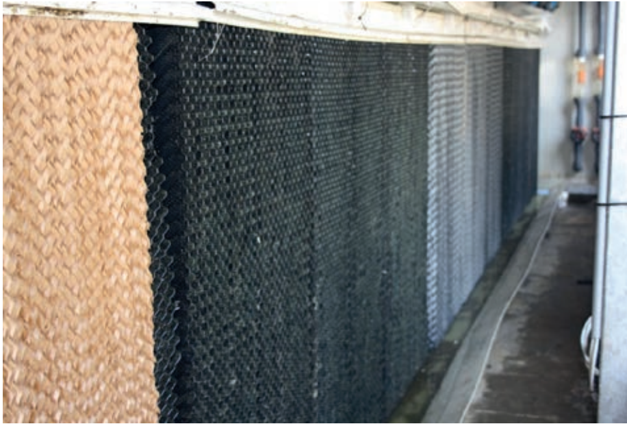
Figuur 6.9. Foto van de proefopstelling waarop de drie verschillende materialen te zien zijn
