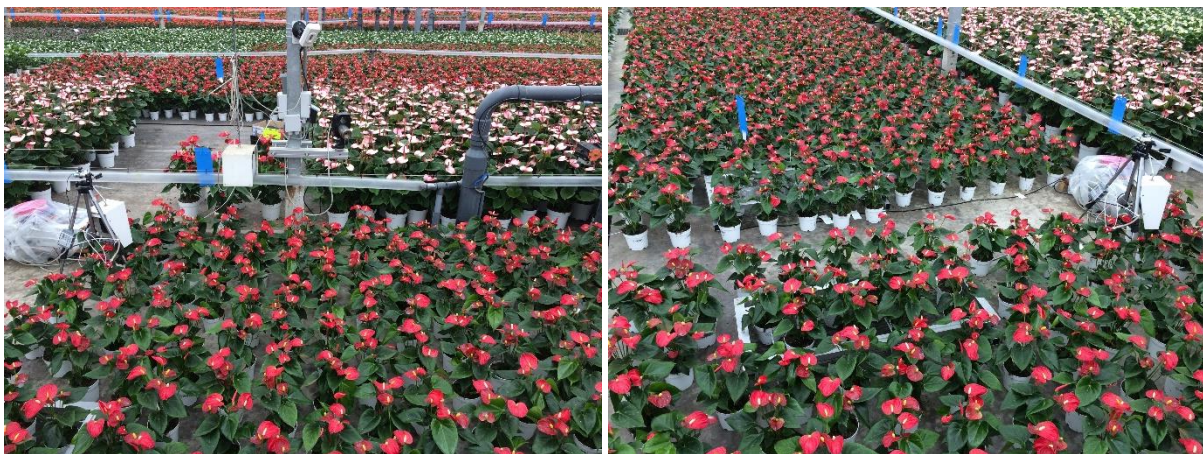
Foto 3. Links: Meetopstelling bij Stolk Brothers: klimaatbox, PT-meter en thermoview bij en aan de kaspoort. Rechts: twee weeggoten.
