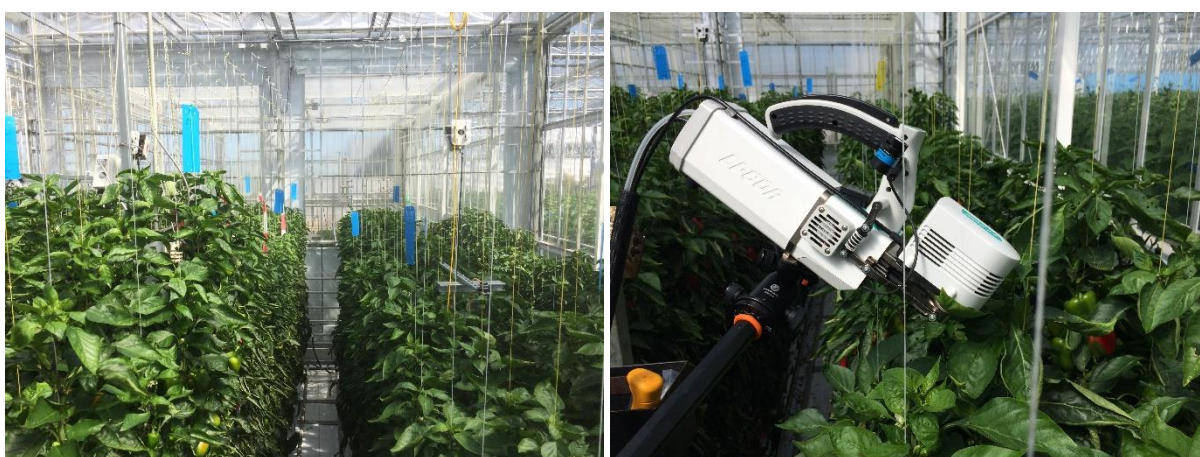
Foto 5. Links: Meetopstelling bij Delphy Improvement Centre: klimaatbox, PT-meter, PAR-meter en thermoview (2*). Rechts: Li-6800 draagbare fotosynthesemeter.
