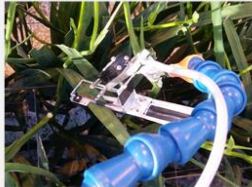
Figuur: HEX-PAM meetkop gepositioneerd op gebogen Freesia blad op ca. 1/3 van de top van het blad.
