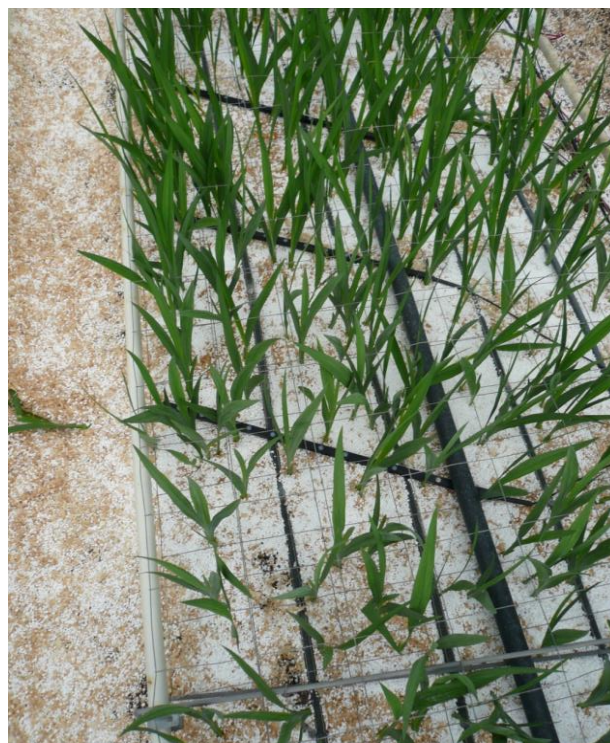
Foto's: positie van de lijnsensoren in het gewas (totaal 4 stuks) en 1 referentiesensor boven het gewas. Datum is 4 september met gewasleeftijd van 31 dagen.
