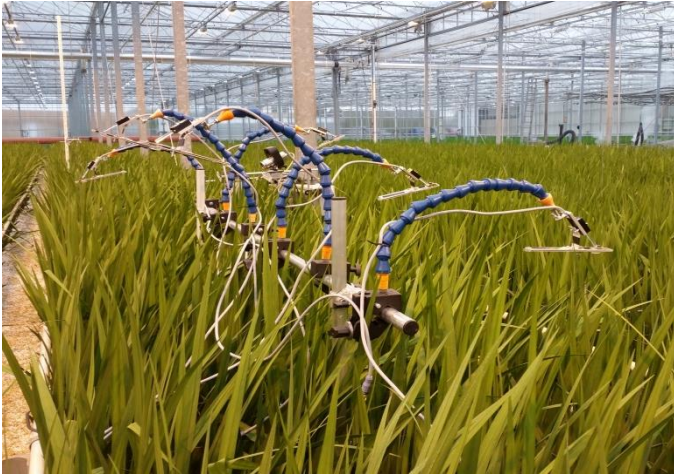
Figuur 5.3. De meetopstelling met de HEX-PAM sensoren gemonteerd aan flexibele zwanehalzen die met klemmen aan de steigerbuis bevestigd zijn.
